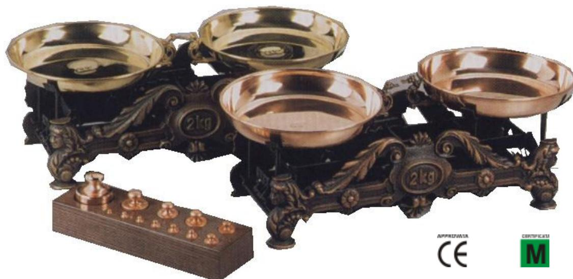
Bilancia in ghisa ottonata o ramata, piatti in ottone o rame del diametro 190 mm, e parti metalliche brunate. Serie di pesi in ottone con zoccolo legno aperto. Portata Kg. 2, sensibilità g 2. Sia la bilancia che i pesi sono bollati dall'ufficio metrico.
